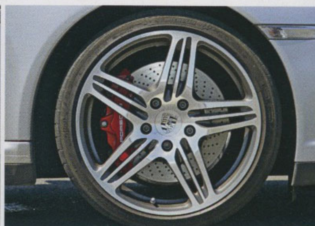
Die 997-Felgen (rechts) sind im Durchmesser ein Zoll größer, die Bremsscheiben um 20 Millimeter
