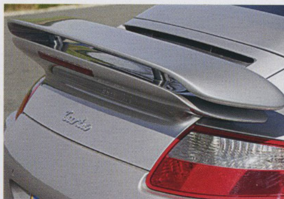
Die Fläche des Heckflügels wurde beim 997 (links) um 23 Prozent vergrößert
