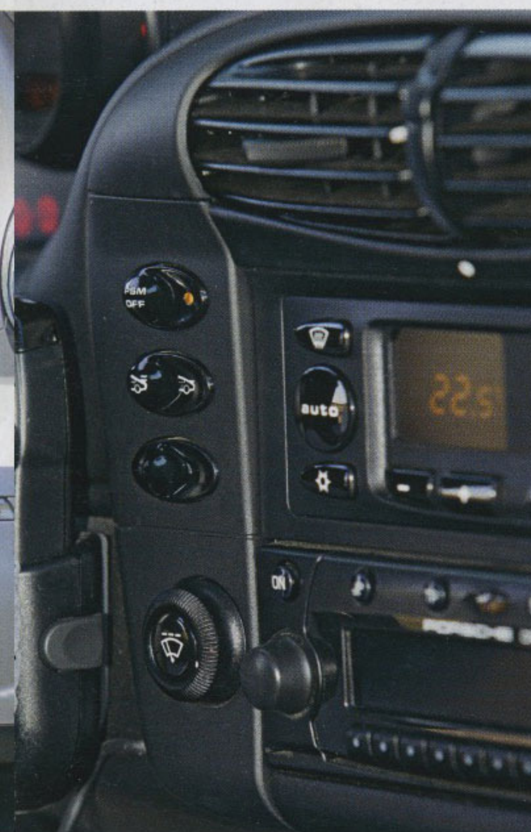
Mit den elektronischen Regelungen wuchs auch die Anzahl der Bedienelemente (997 rechts)
