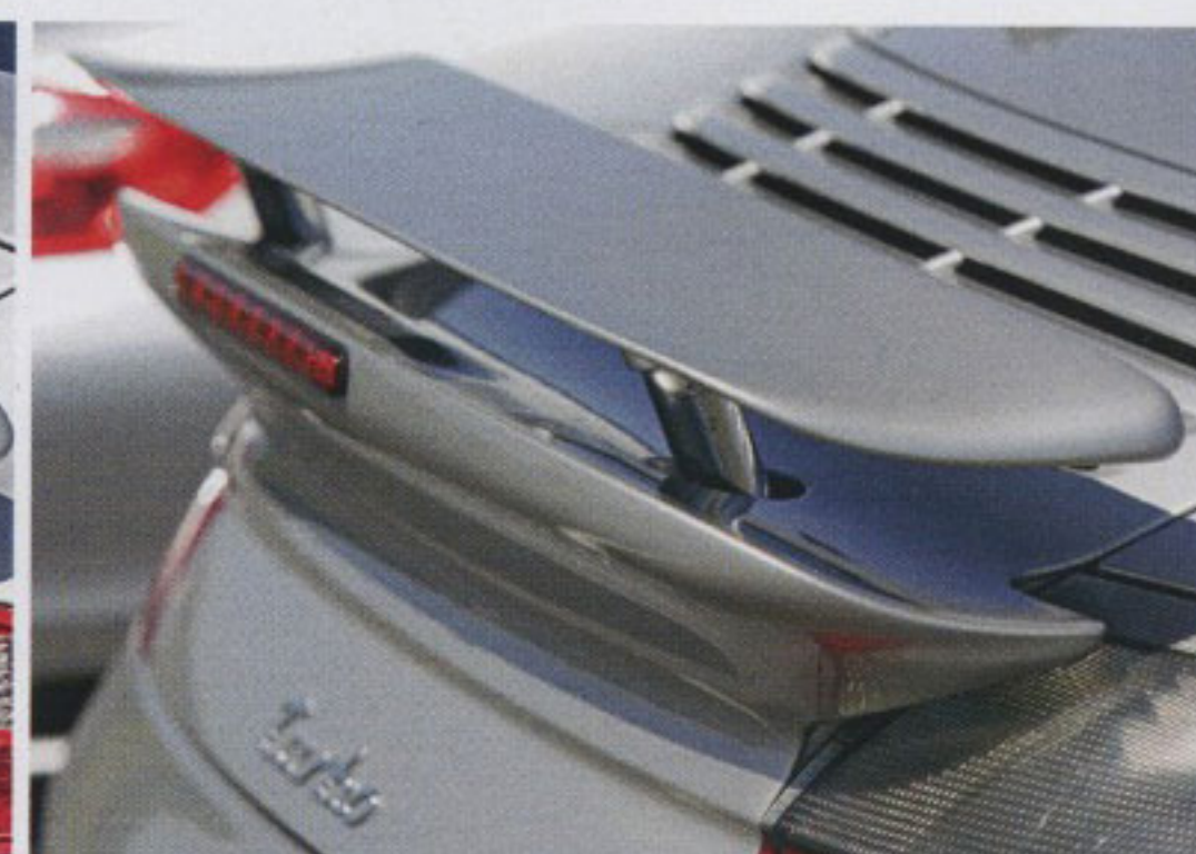
Die Fläche des Heckflügels wurde beim 997 (links) um 23 Prozent vergrößert
