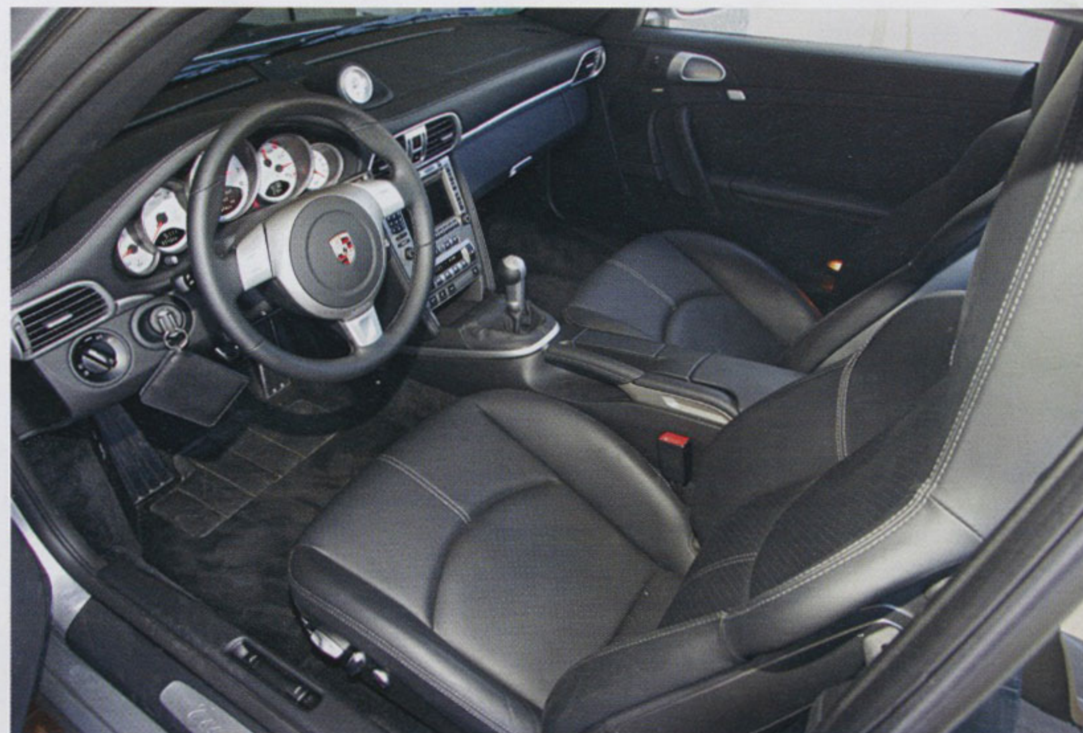
Adaptive Sitze mit aufblasbarer Abstützung waren eine Option im 997
