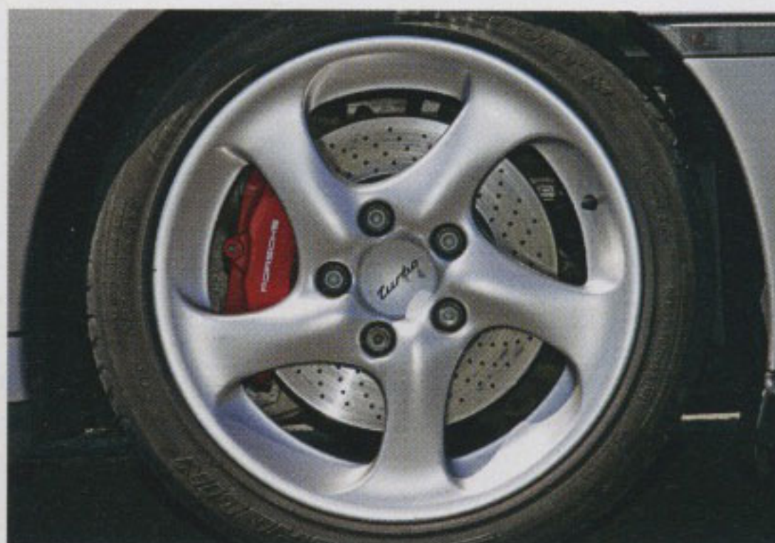
Die 997-Felgen (rechts) sind im Durchmesser ein Zoll größer, die Bremsscheiben um 20 Millimeter
