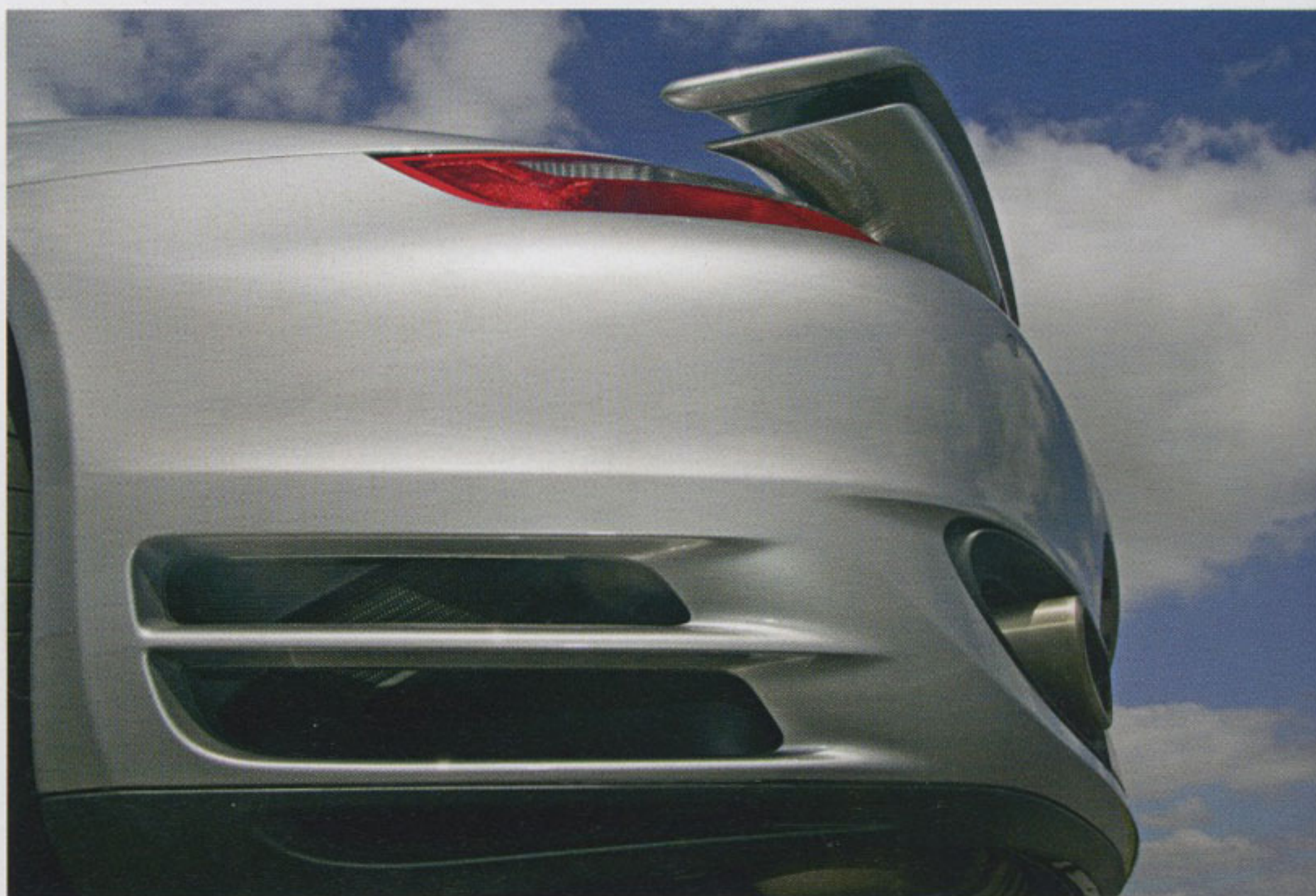
Seitliche Kiemen im hinteren Stoßfänger lassen heiße Ladekühlerluft entweichen
