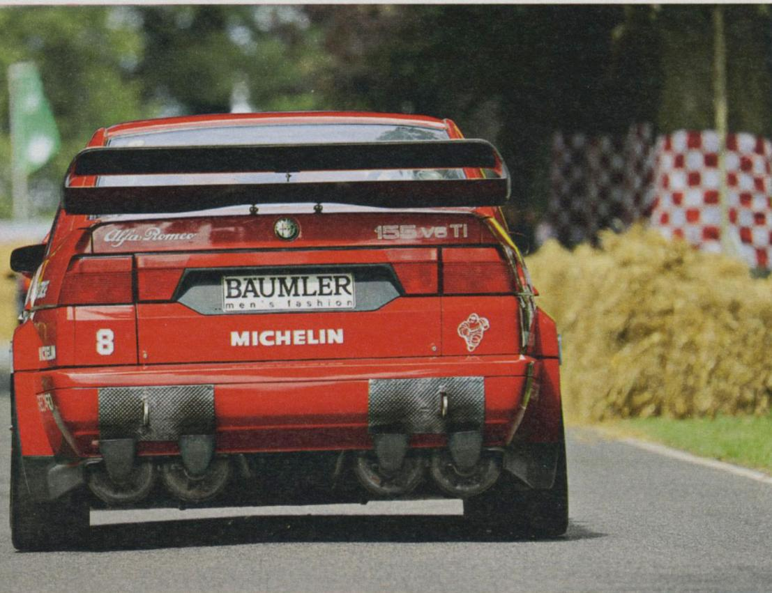
Aus vier hochgebogenen Endrohren schrillt der V6, brüllt frei saugend und (fast) frei auspuffend
