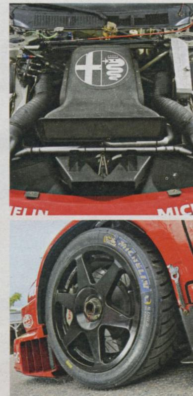
Für Wartungsarbeiten lässt sich der vordere Aufbau am Stück entfernen. Dann liegt das riesige Ansaugsystem frei. Vom Rennmotor selbst ist leider wenig zu sehen
