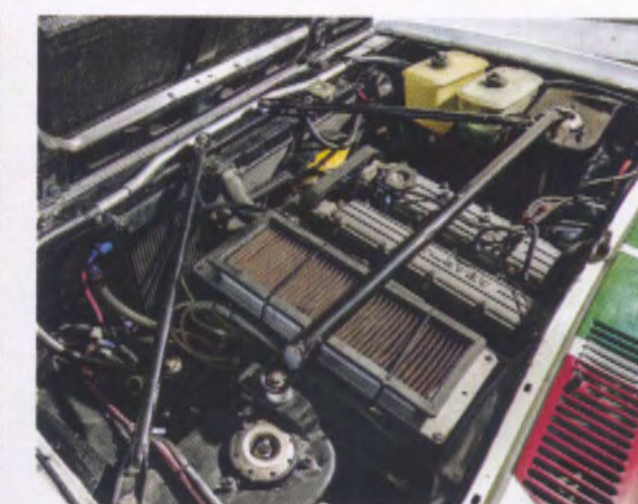
Volo acrobatico Due passaggi spettacolari della 131 Abarth Alitalia tra un cordolo e l’altro della pista di Vairano (PV). Sotto a sinistra, l’affollata plancia, la barra duomi nel vano motore (sotto) e il serbatoio olio del carter secco, posto nel bagagliaio (in basso).
