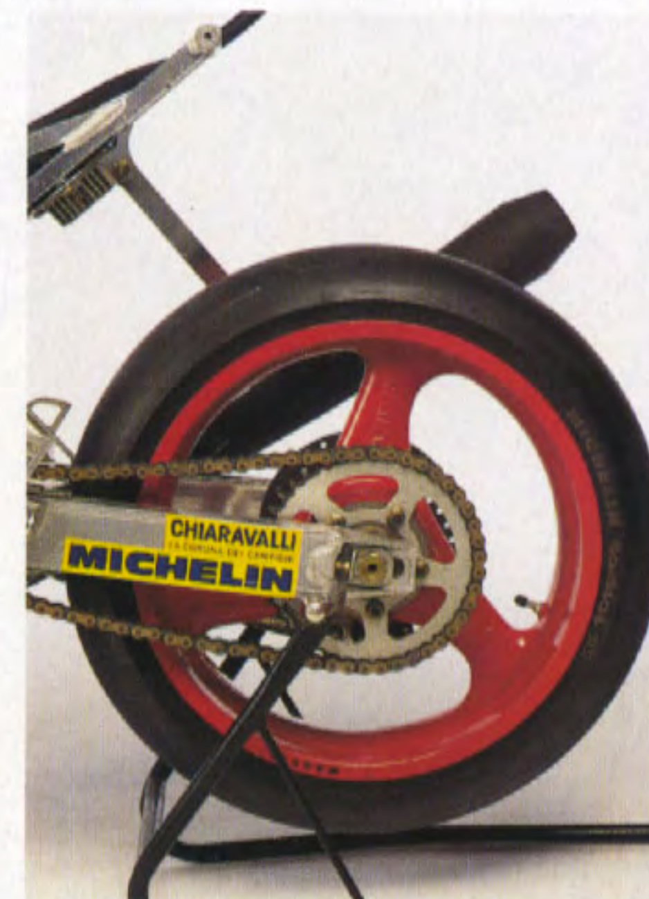
In alto, uguali anche i coperchi del motore. Sulla macchina da corsa è stato applicato un tappo al posto dell'asse del pedale della messa in moto. Al centro, il forcellone della moto da corsa è in alluminio mentre è d'acciaio sulla moto stradale. In basso, il grosso carburatore della moto da corsa.
