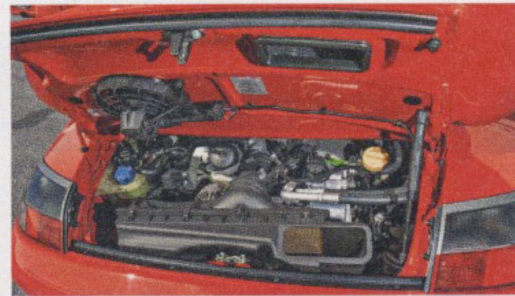
Mit einer Literleistung von 100 PS und mehr ist der GT3-Boxer ein reinrassiger Sportmotor
