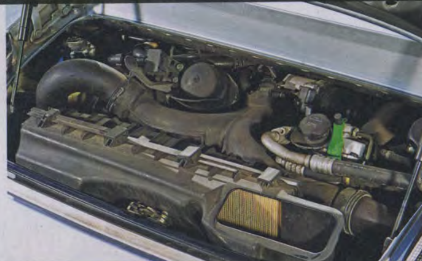
Anders als die 996-Sauger basiert der Turbo-Motor noch auf dem Kurbelgehäuse der luftgekühlten Vorgänger und besitzt Trockensumpfschmierung
