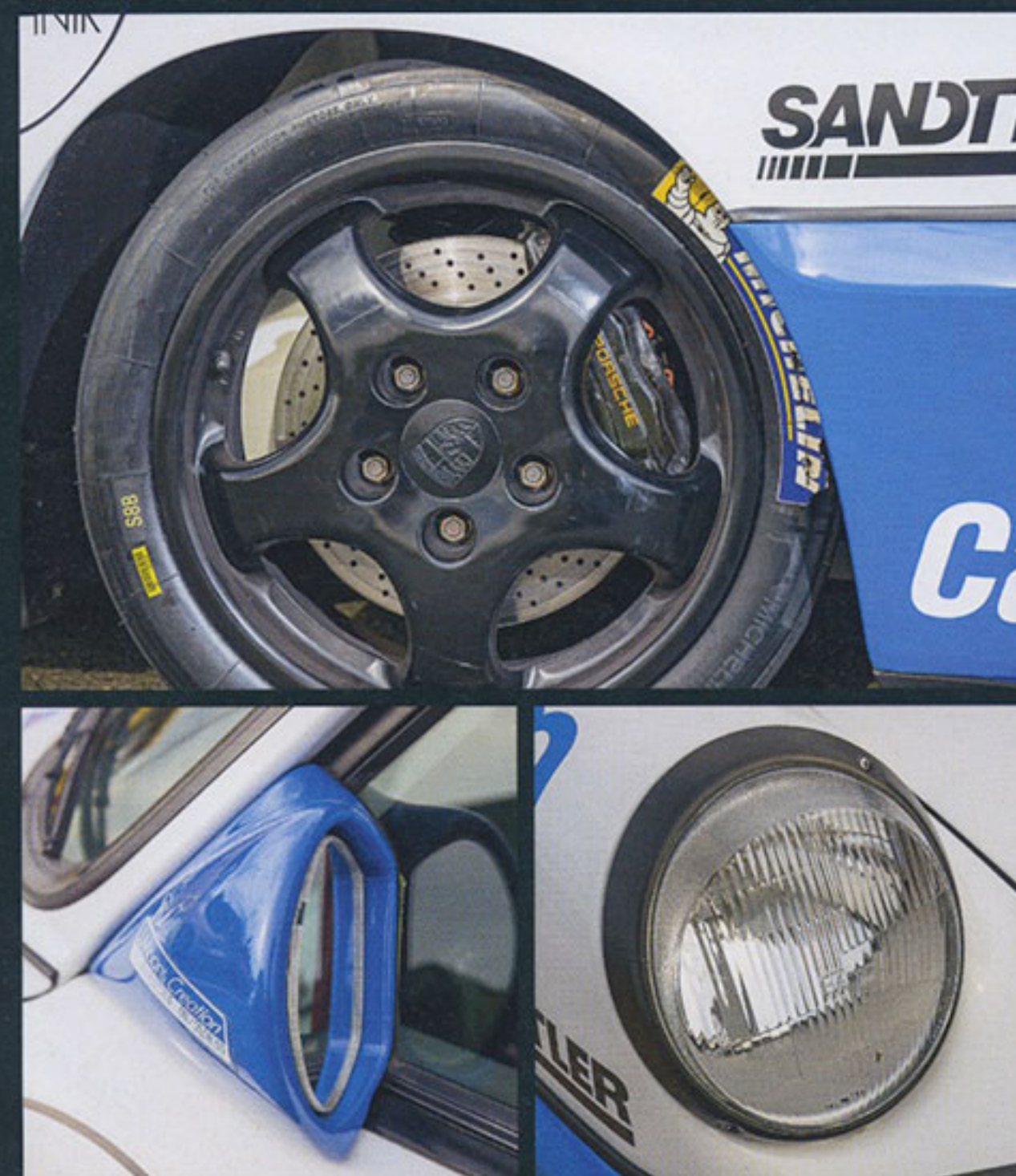
Die 17-Zoll-Rennfelgen von Speedline erinnern an 959er-Räder, die aerodynamisch geformten Rückspiegel sind Rennzubehör, die Scheinwerfer kommen aus der Serie
