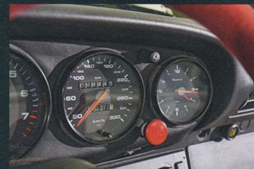
Der Cup-Elfer verfügt nur über ein spartanisches Interieur. Der Instrumententräger hat als Rennausstattung einen „Not-aus“-Knopf
