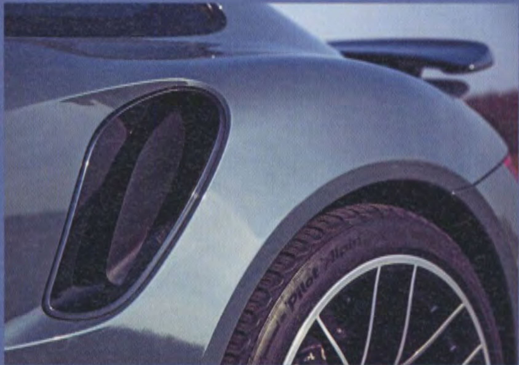
Neues Cockpit mit Multi-Funktionsanzeige und ausgeprägter Mittelkonsole. Dominante Einlässe vor den hinteren Radhäusern versorgen die Ladeluftkühler mit Frischluft
