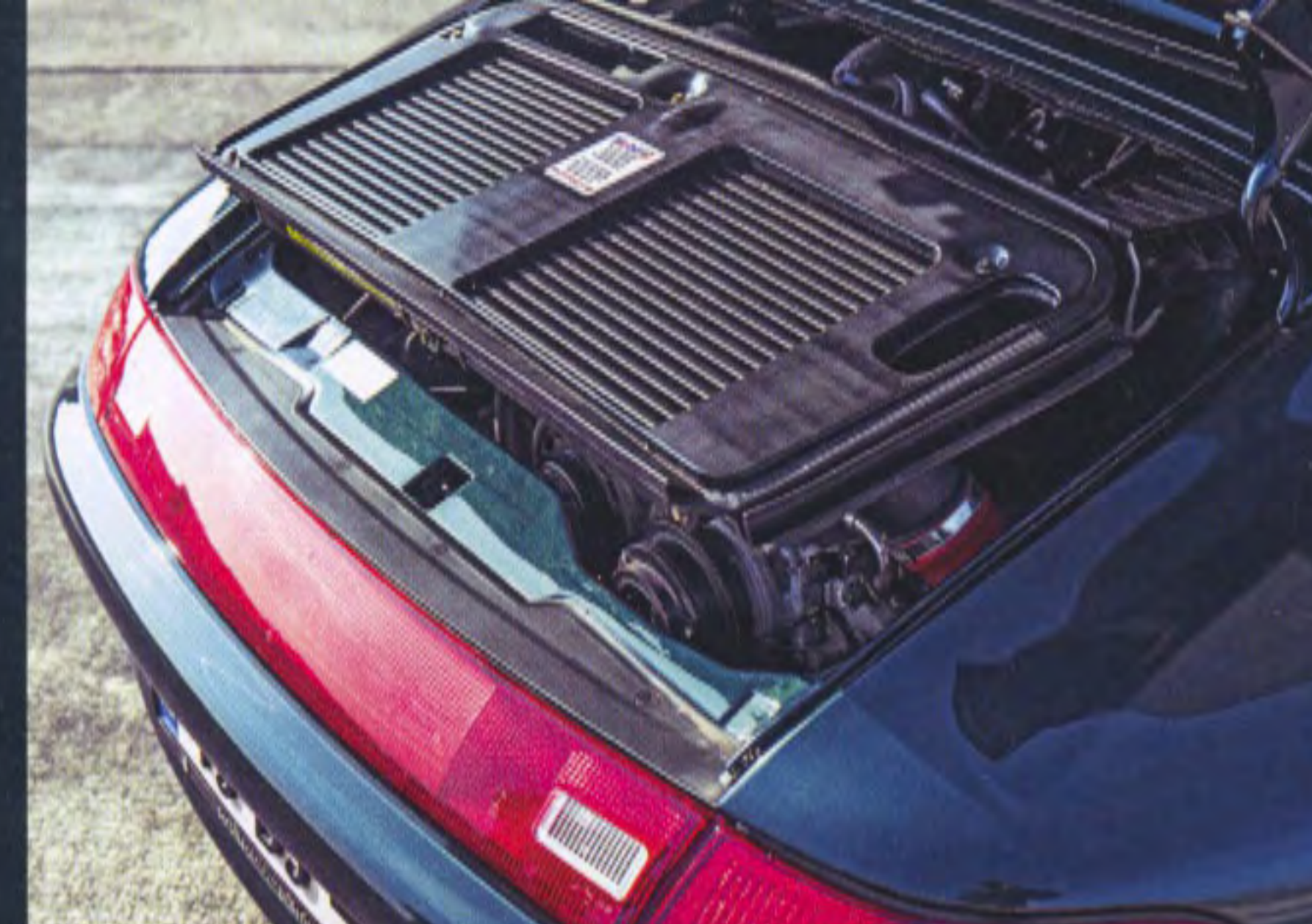
3,6-Liter-Motor mit 450 PS, gemeinsamer Ladeluftkühler für zwei Turbolader (links). Wenig Neues gab es im 993-Cockpit (oben). Aerodynamik und Felgen kamen in komplett neuem Design
