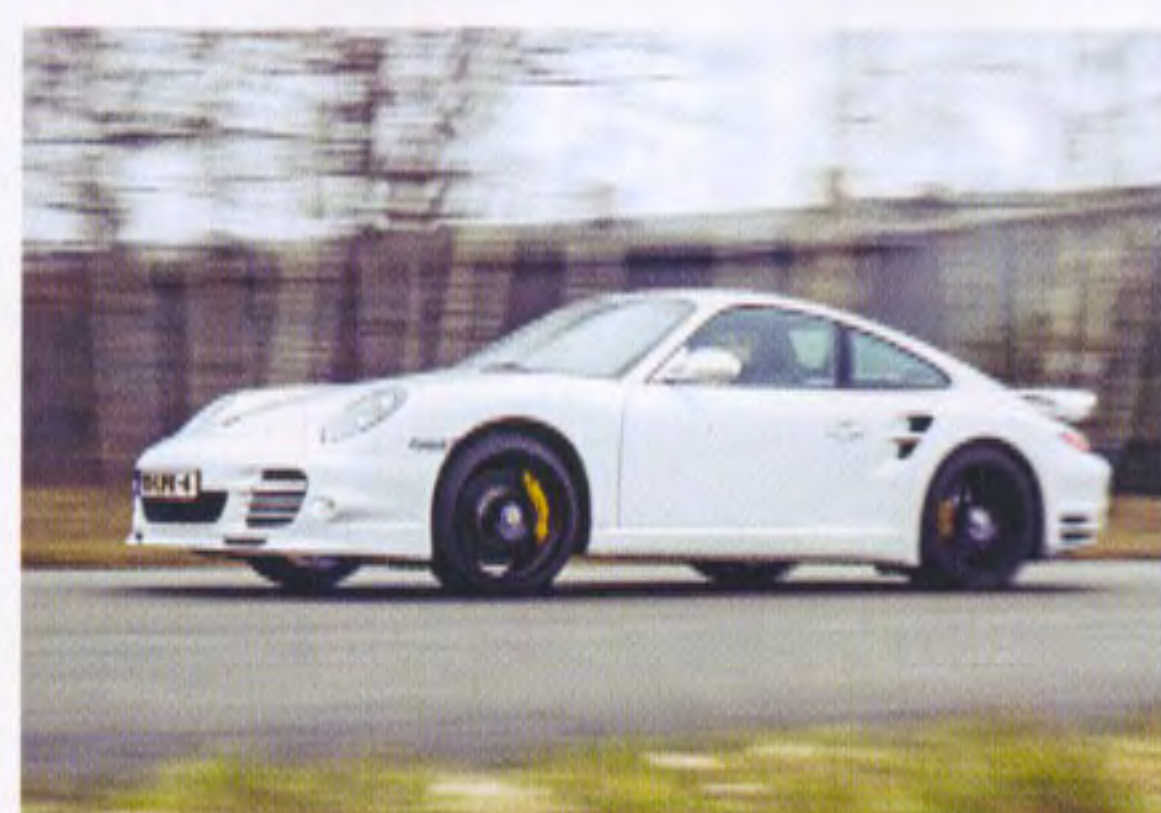
Zentralverschluss-Felgen und Keramikbremsen gab es beim 997 gegen Aufpreis, dazu zunächst eine überarbeitete Tiptronic S. Das PDK kam erst 2010 mit der zweiten 997-Generation und dem 3,8-Liter-Motor
