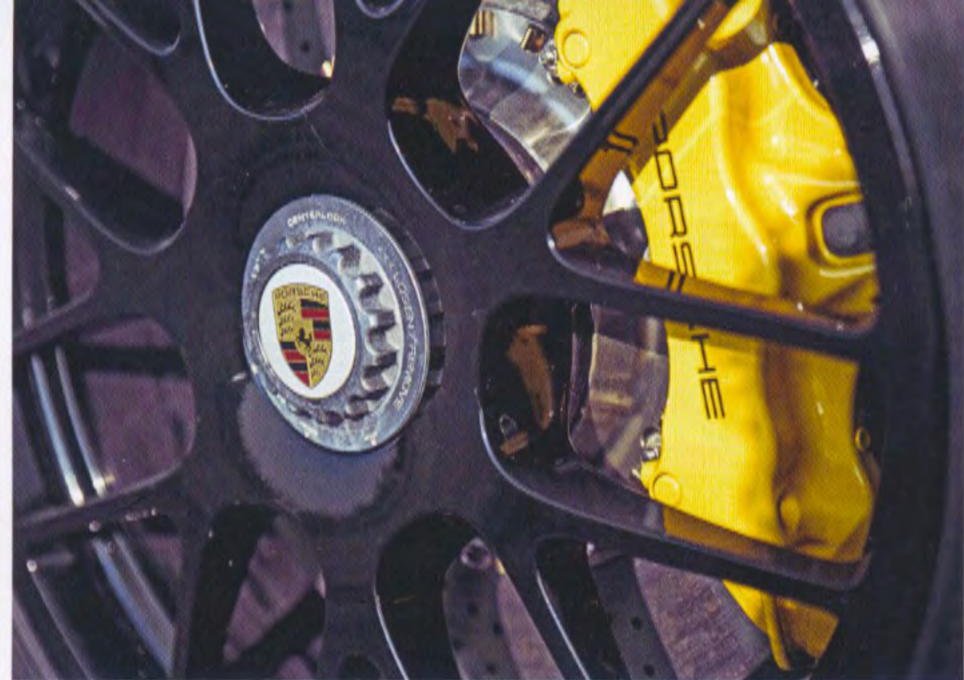
Zentralverschluss-Felgen und Keramikbremsen gab es beim 997 gegen Aufpreis, dazu zunächst eine überarbeitete Tiptronic S. Das PDK kam erst 2010 mit der zweiten 997-Generation und dem 3,8-Liter-Motor
