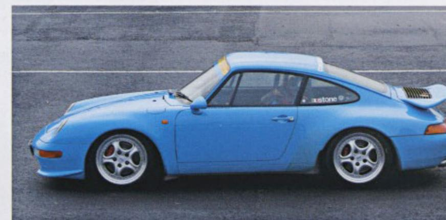
piantata a terra, beneficia della massiccia impronta dei pneumatici e dell'assetto irrigidito, che limita vistosamente gli angoli di rollio e beccheggio; la taratura rigida del sistema sospensivo comunica ogni più piccola asperità del terreno; lo sterzo, senza servoassistenza, è
