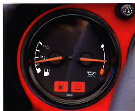
2 Niveaux d'essence et d'huile. Celui-ci se lit moteur chaud et tournant, au ralenti sur une surface plate
