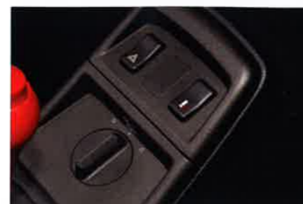
10 La molette permet de monter et baisser l'aile à l'arrêt, si on veut le nettoyer
