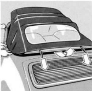
Heckscheibenteil faltenfrei über das Verdeck nach vorne ablegen. Fondhaube seitlich mit beiden Händen (Pfeile) gleichzeitig anheben.
