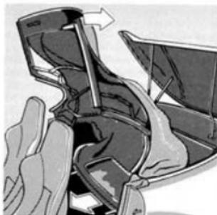
Heckscheibenteil nach oben ziehen und Zugschlaufen an den Verdeckverschlüssen (Pfeile) so einhängen, daß das Verdeck als Rolle abgelegt ist.
