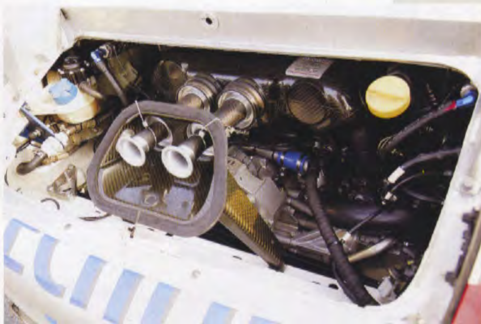
L'impianto d'aspirazione della GT3 RSR prevede, per regolamento, due flange da 29 mm. Sotto, l'ampia ala posteriore regolabile in 12 posizioni.
