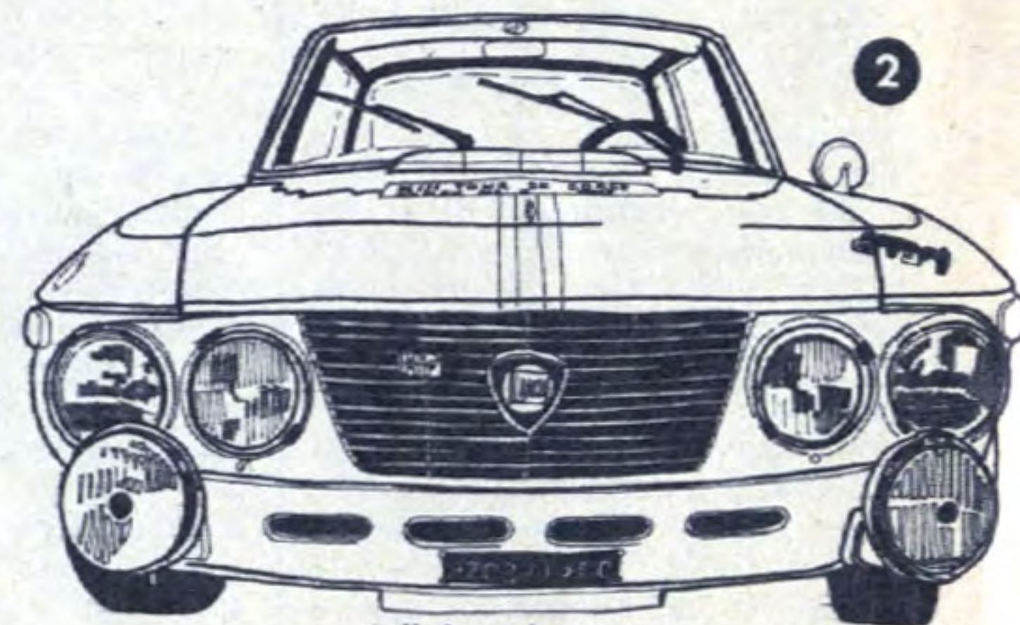
Il frontale della Fulvia HFR con i fari italiani prodotti dalla Carello
