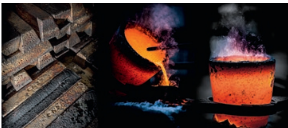
Von links nach rechts: Aus solchen Bronzebarren fertigt Steffen Imhof seine Kunstwerke; in einem Schmelztiegel werden die Barren eingeschmolzen; die flüssige Bronze wird bei 1200 Grad Celsius in die Gussform gefüllt.
