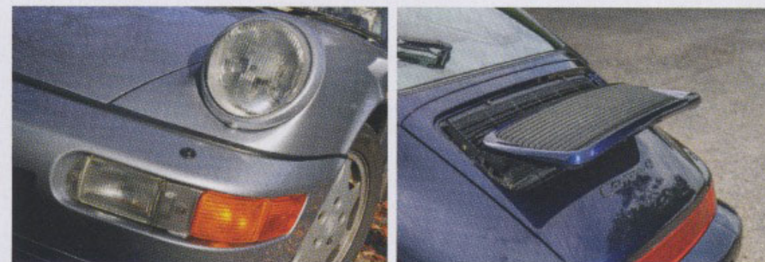
Schwarzer Keder zwischen Plastiknase und Karosserieblech
