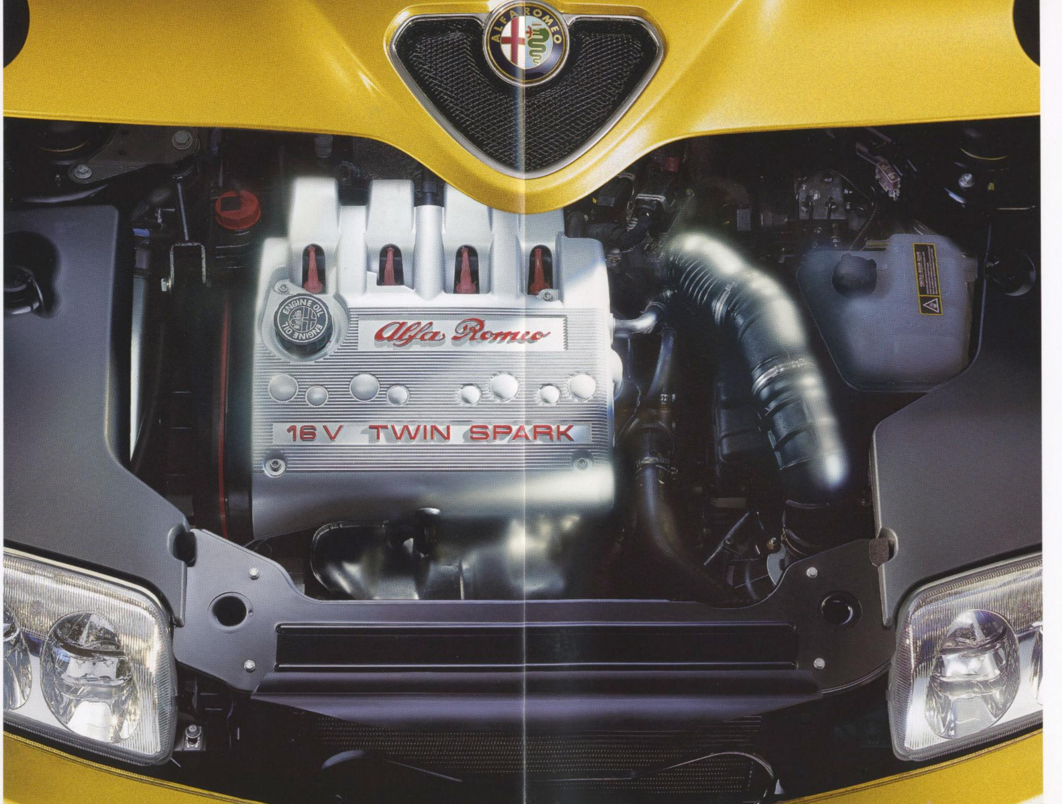
Der klassische 2.0 Twin Spark 16V: Vier Zylinder in Reihe, Doppelzündung für eine schnellere und sauberere Verbrennung. Variable Ansauggeometrie und Phasenschieber sorgen für eine optimale Treibstoffversorgung und maximale Elastizitätswerte auch im niedrigeren Drehzahlbereich. Zwei gegenläufige Ausgleichswellen garantieren eine Laufruhe, die vergleichbar ist mit der eines Sechszylinders. 150 PS für eine Höchstgeschwindigkeit von 210 km/h, 8,5 Sekunden für den Sprint von 0 auf 100 km/h.
