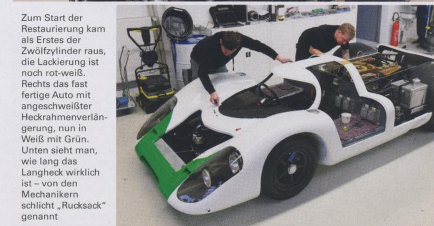
Zum Start der Restaurierung kam als Erstes der Zwölfzylinder raus, die Lackierung ist noch rot-weiß. Rechts das fast fertige Auto mit angeschweißter Heckrahmenverlängerung, nun in Weiß mit Grün. Unten sieht man, wie lang das Langheck wirklich ist – von den Mechanikern schlicht „Rucksack“ genannt
