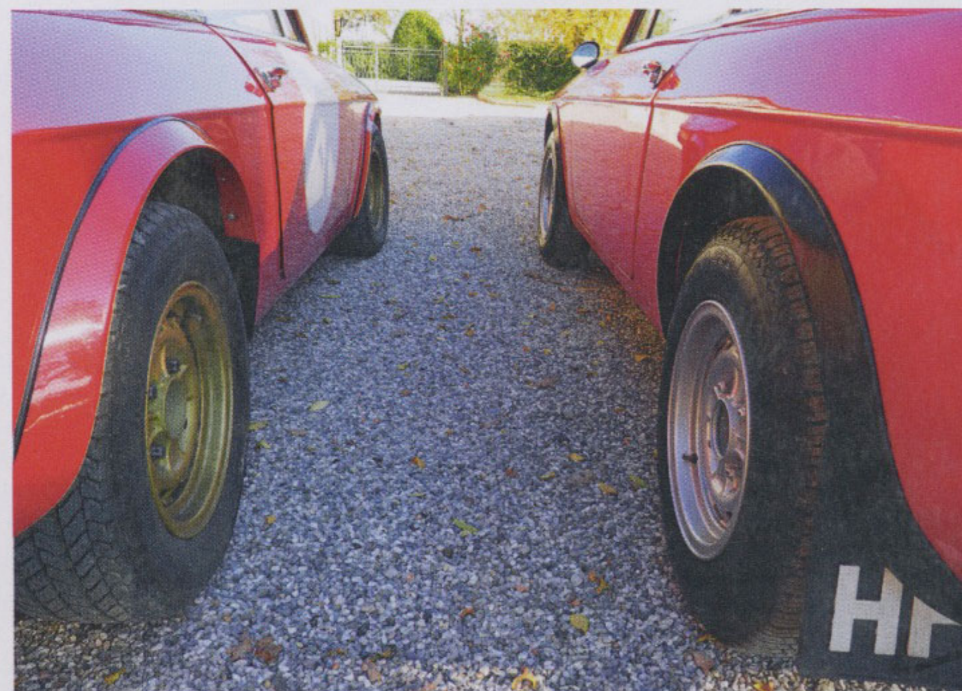
La scocca nelle versioni Gr. 4, su richiesta, poteva nascere anche con i codolini passaruota rialzati e ampliati rispetto alla versione stradale, con il taglio dei passaruota ribattuto e rialzato fino all'altezza della nervatura longitudinale della vettura. Si osserva anche il camper negativo anteriore, e gli splendidi cerchi Campagnolo.
