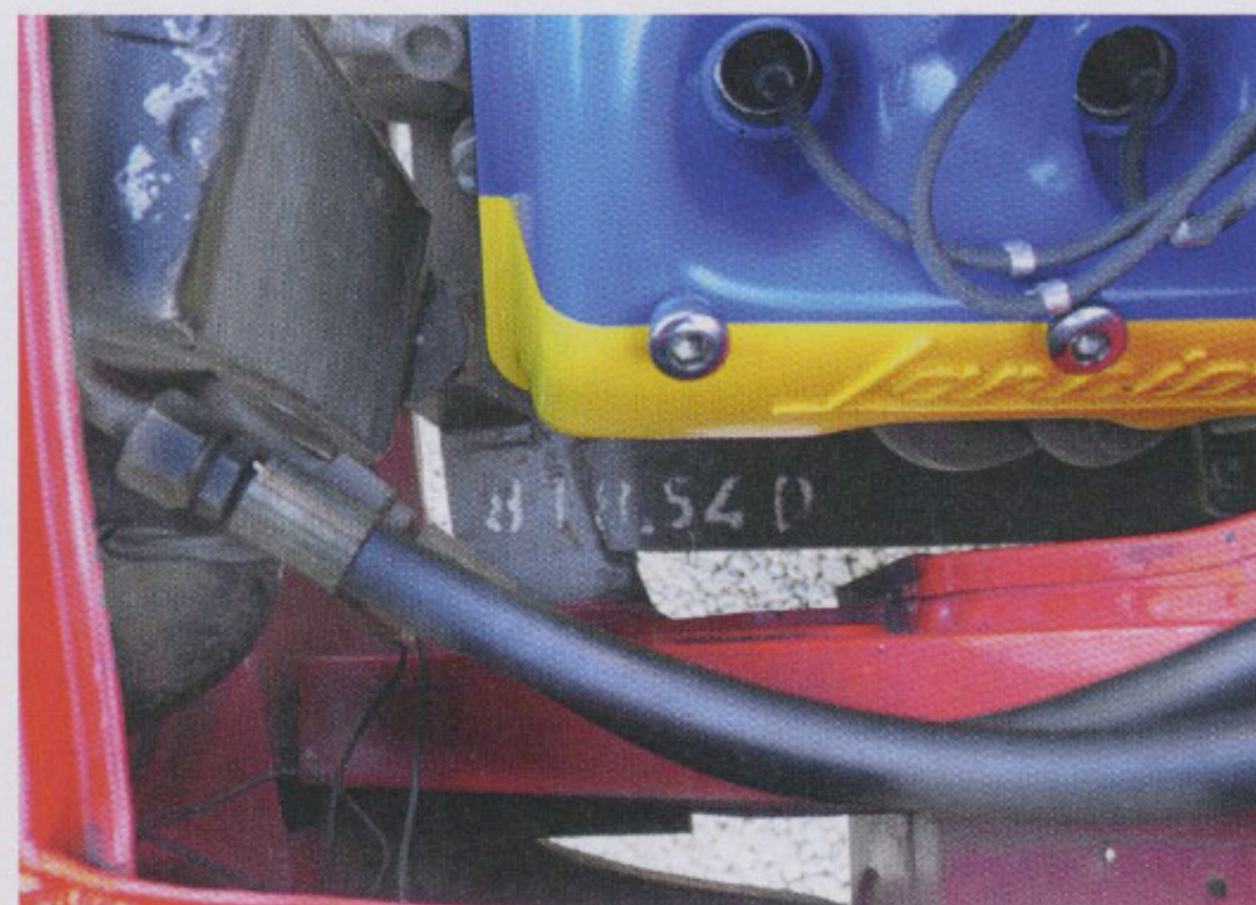
Collettore di scarico nella Fulvia HF 1,6 stradale, e più prominente, quello del gr.4: era necessaria una modifica della lamiera al sottomotore anteriore sinistro che separava i collettori dalla gomma. In queste immagini si nota l'assenza del radiatore dell'olio nella vettura da gara. Interessante la "timbratura" 818.540 sui telaietti motore originali.
