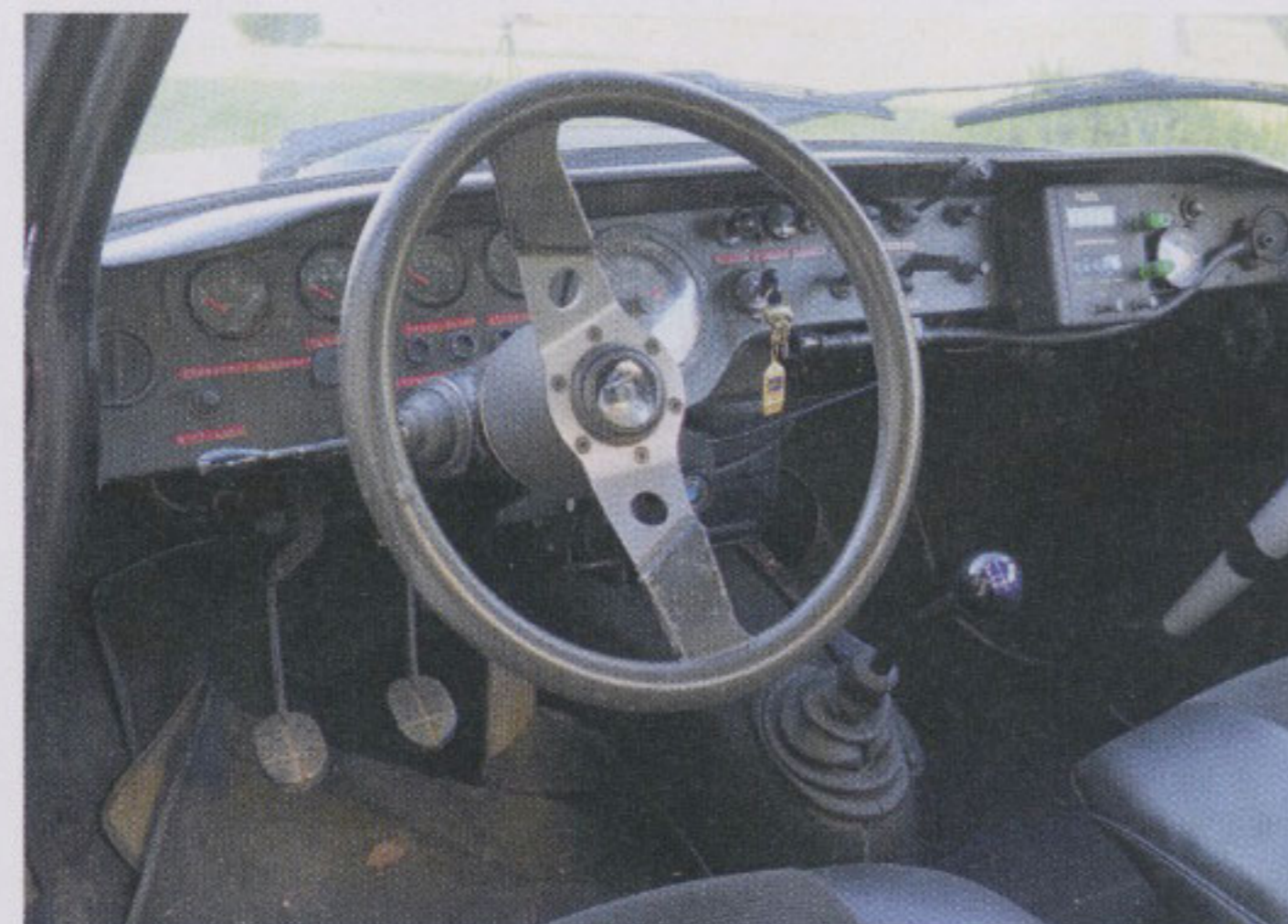
Cruscotto stradale con tachimetro con fondo scala di 220 Km/h e contagiri meccanico tarato a 10.000 giri, con lancetta che segnava il numero di giri e poteva essere azzerato. Accanto, il cruscotto corsaiolo, con volante Ferrero, gli strumenti essenziali per il pilota erano distribuiti prevalentemente dal lato navigatore.
