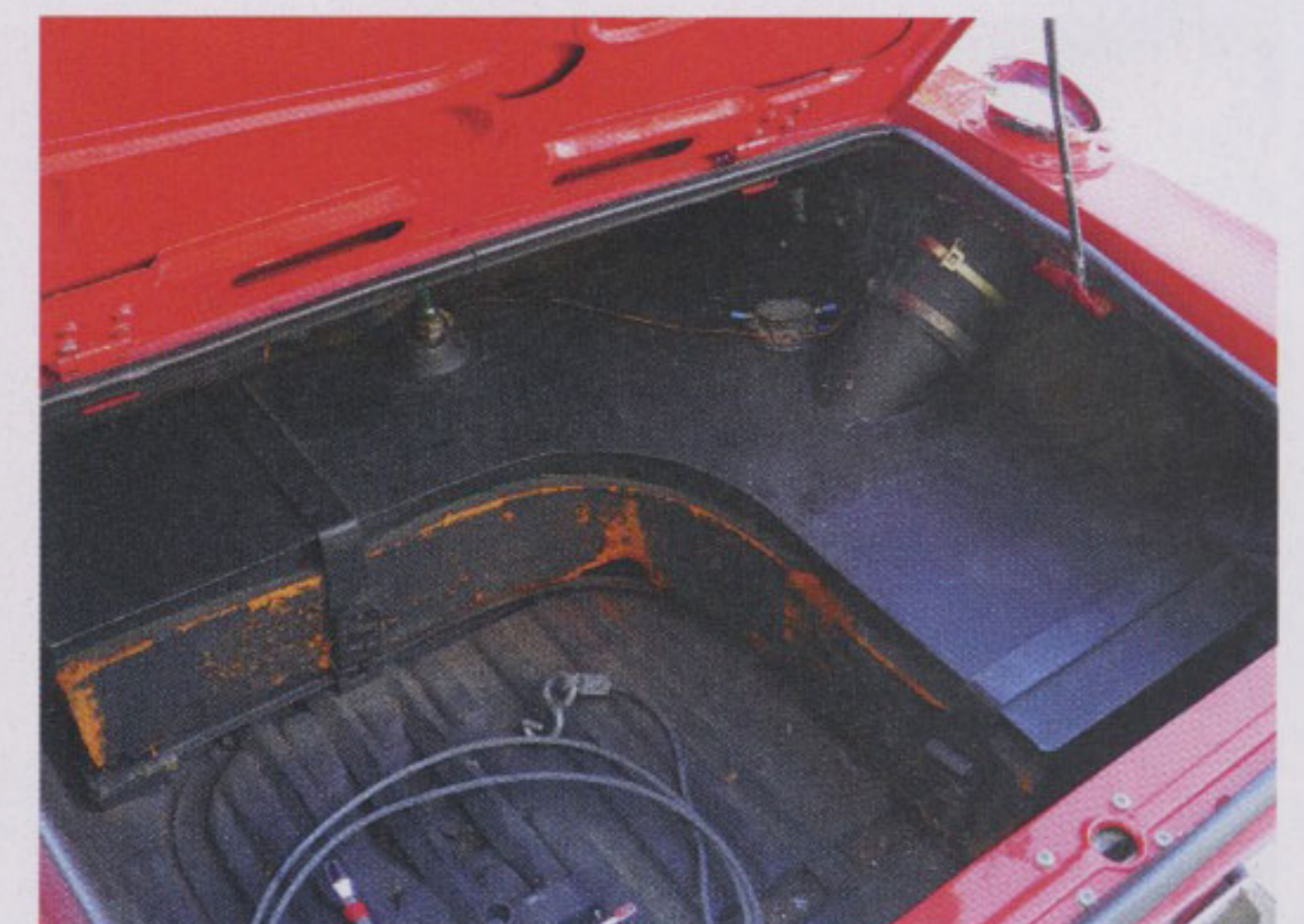
Diverse erano le forme del parafrangente destro, nel gruppo 4 è evidente il tappo carburante "rapido" e l'assenza dello sportellino sul fianco. All'interno del bagagliaio della versione da gara prendeva posto il serbatoio supplementare che poteva essere da 60 o da 90 litri. In questo esemplare il serbatoio è quello più piccolo, da 60 litri.
