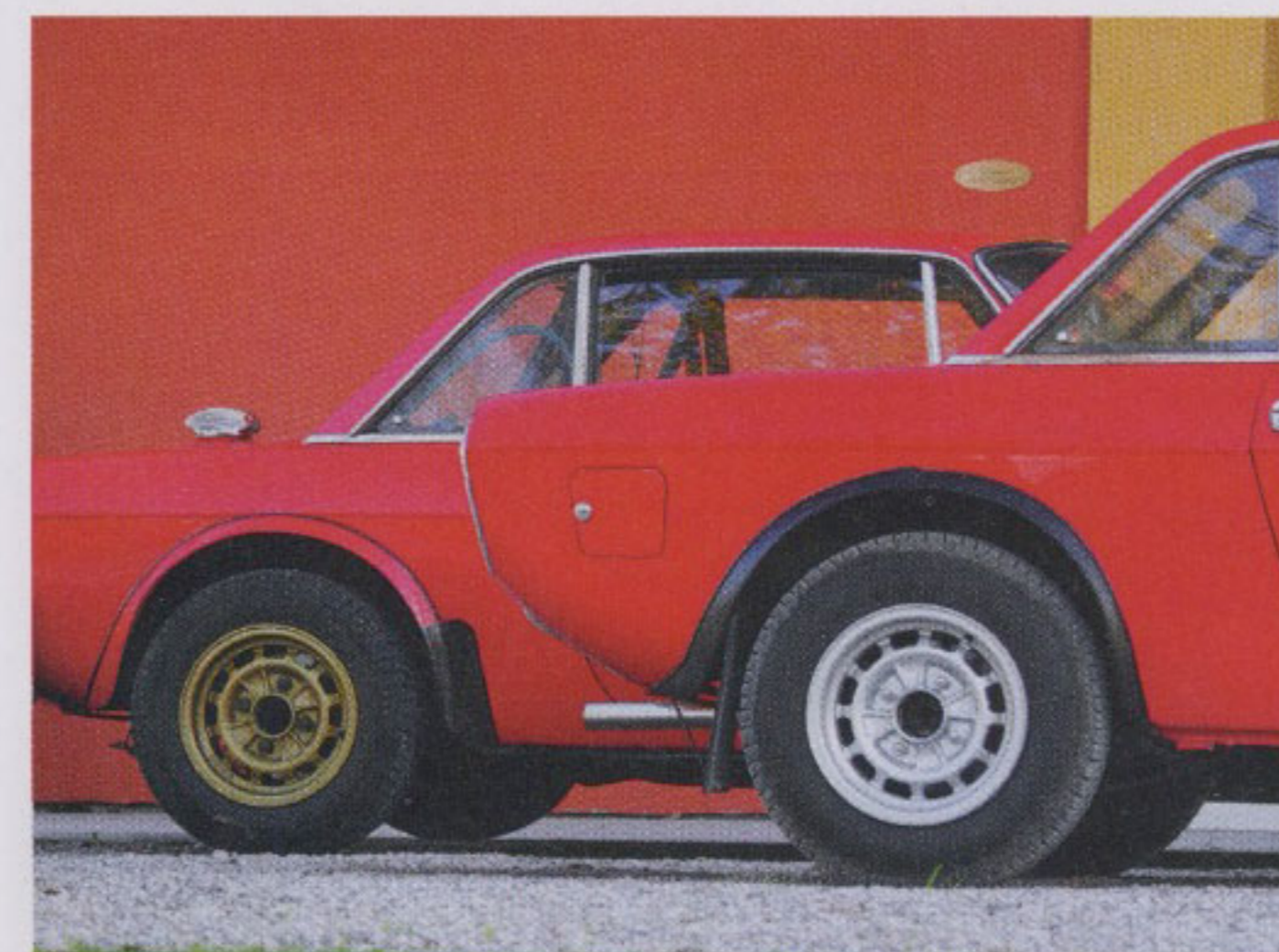
Diverse erano le forme del parafrangente destro, nel gruppo 4 è evidente il tappo carburante "rapido" e l'assenza dello sportellino sul fianco. All'interno del bagagliaio della versione da gara prendeva posto il serbatoio supplementare che poteva essere da 60 o da 90 litri. In questo esemplare il serbatoio è quello più piccolo, da 60 litri.
