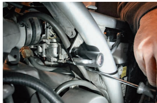
Verbaut: Die Schwimmerkammer-Ablassschraube ist nur per Spezial-Schraubendreher erreichbar
