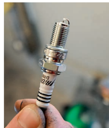
Fast zu schön zum Versenken: NGK Iridiumkerze. 19,99 Euro für besseres Startverhalten und gleichmäßigere Verbrennung
