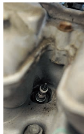
Fast zu schön zum Versenken: NGK Iridiumkerze. 19,99 Euro für besseres Startverhalten und gleichmäßigere Verbrennung
