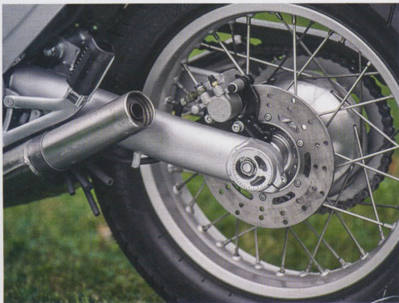
Ovalprofilschwinge und solide Exzenter für die Aufnahme der Hinterradachse. Die Hardware der Moto 6.5 ist durchaus ansehnlich gemacht
