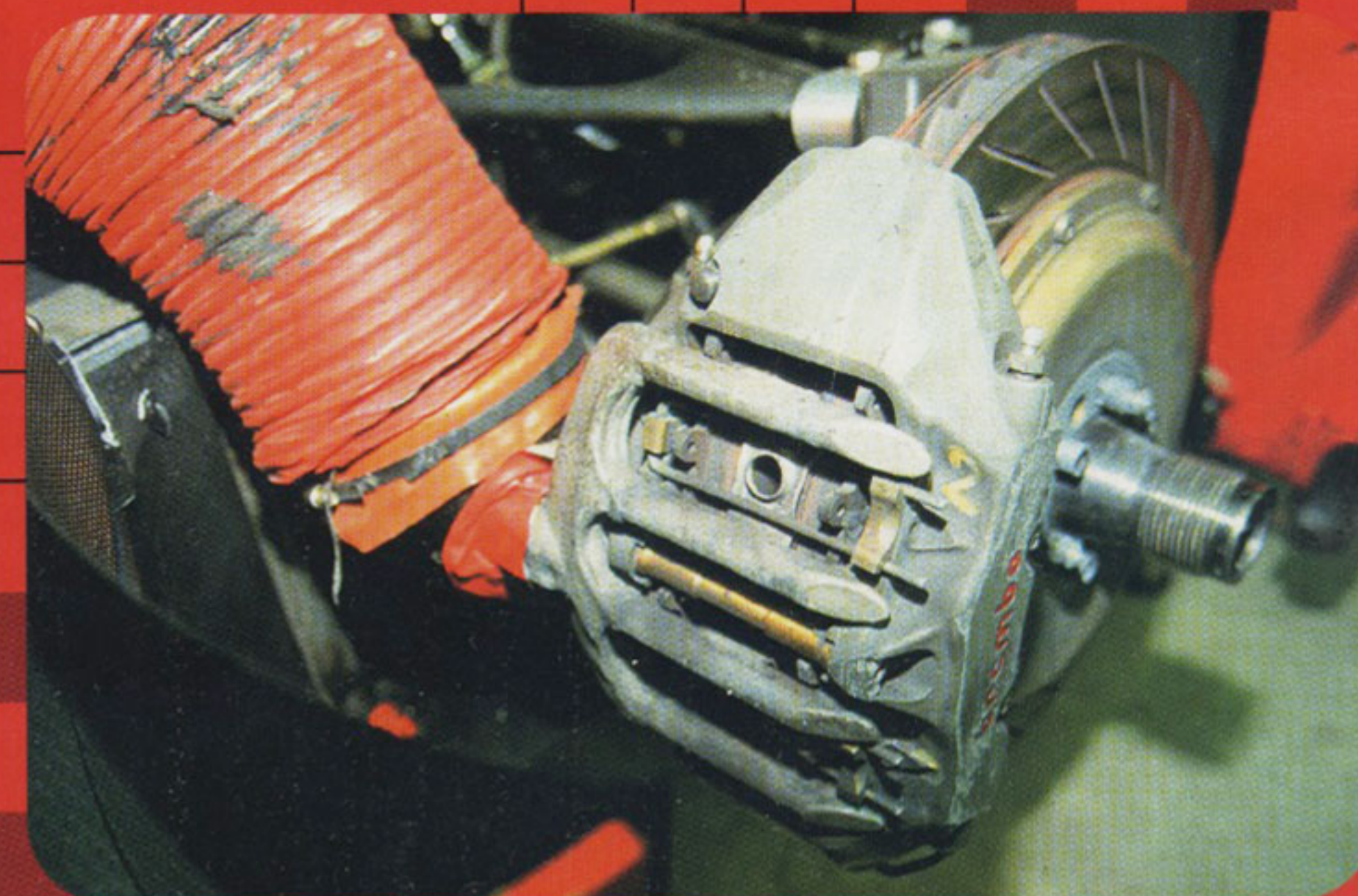
La pinza freno (Brembo ad 8 pistoncini) lavora sui dischi scomponibili da 380 mm ed è raffreddata da un convogliatore d'aria.
