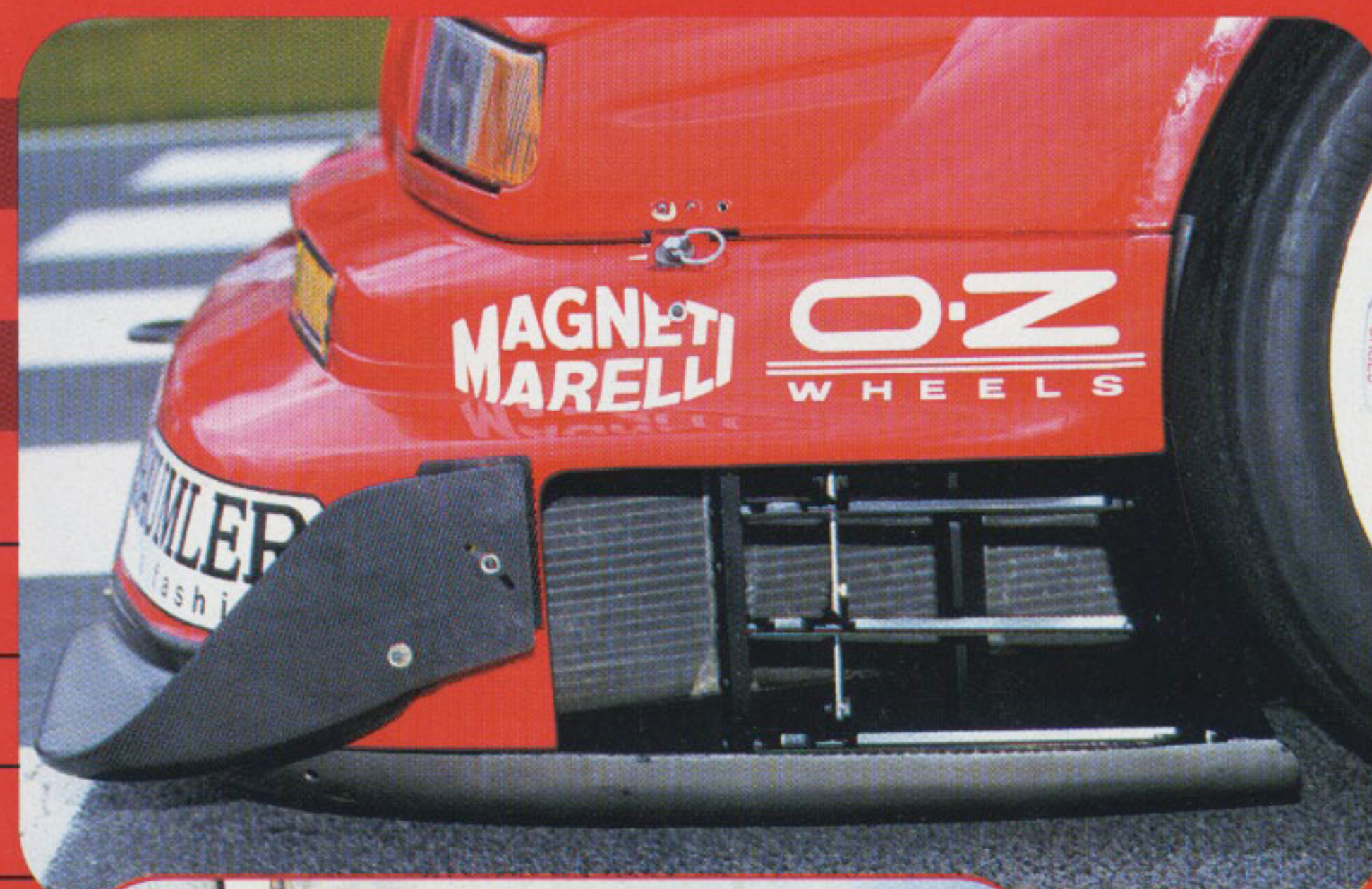
Un particolare degli scambiatori di calore dell'acqua e dell'olio in una insolita posizione. A fianco il doppio terminale di scarico che permette di intravedere il catalizzatore interno.
