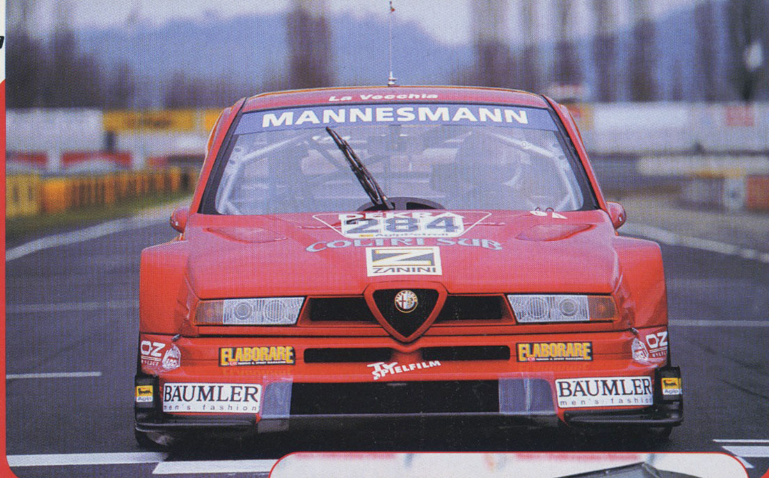
L'aggressivo frontale della 155 ITC, dove spiccano le prese d'aria in carbonio. Al posteriore l'alettone regolabile permette di variare il carico aerodinamico a seconda delle esigenze.
