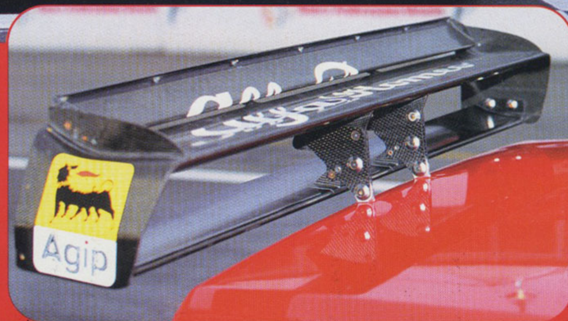
L'aggressivo frontale della 155 ITC, dove spiccano le prese d'aria in carbonio. Al posteriore l'alettone regolabile permette di variare il carico aerodinamico a seconda delle esigenze.
