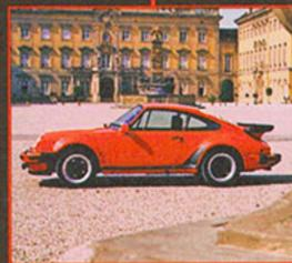
1977 erhält der 3 Liter grosse Sechszylinder-Boxermotor eine Hubraum-erweiterung auf 3,3 Liter, was zusammen mit einer erstmals eingesetzten Ladeluftkühlung eine Leistungssteigerung auf 300 PS ermöglicht. Ab 1986 ist sogar eine Werksleistungssteigerung auf 330 PS verfügbar. Ab 1987 ist der 911 Turbo der Baureihe 930 auch als Cabriolet und Targa erhältlich.
