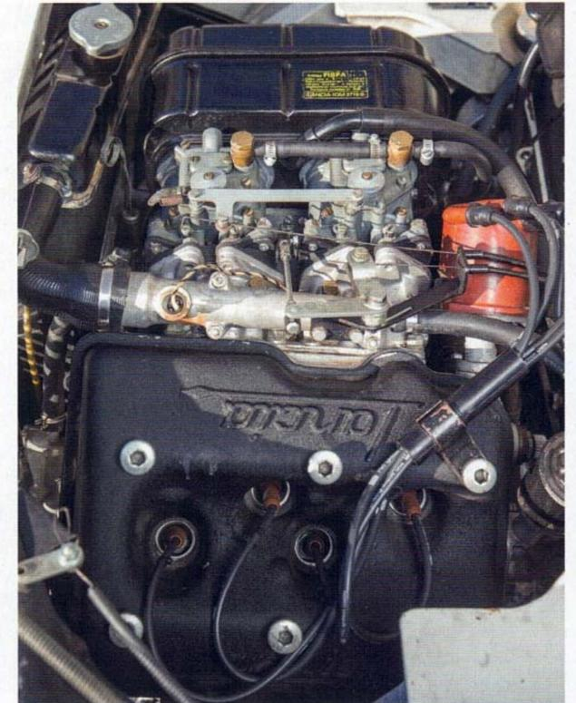
Der Vierzylindermotor ist längs und geneigt eingebaut.
