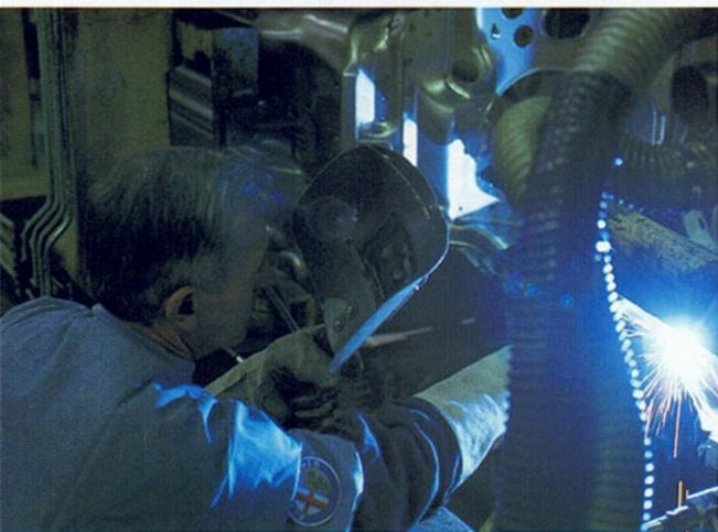
Anche volendo, ci sono operazioni che non potrebbero essere svolte dal robot. La saldatura del padiglione del Gtv, per esempio. Il tetto e i montanti vengono uniti con una saldatura continua praticamente invisibile. Un capolavoro di precisione che richiede l'occhio e la mano di uno specialista.
