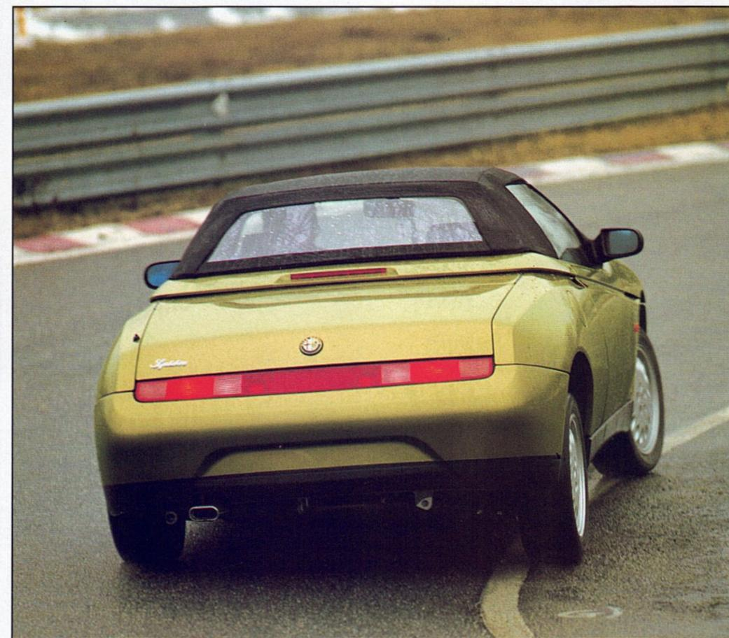
Lo Spider è offerto con due motorizzazioni: il due litri 16 valvole da 150 cavalli e 210 km/h, e il tre litri V6 da 192 cavalli e 223 km/h. Il propulsore due litri V6 turbo è stato riservato al coupé GTV.
