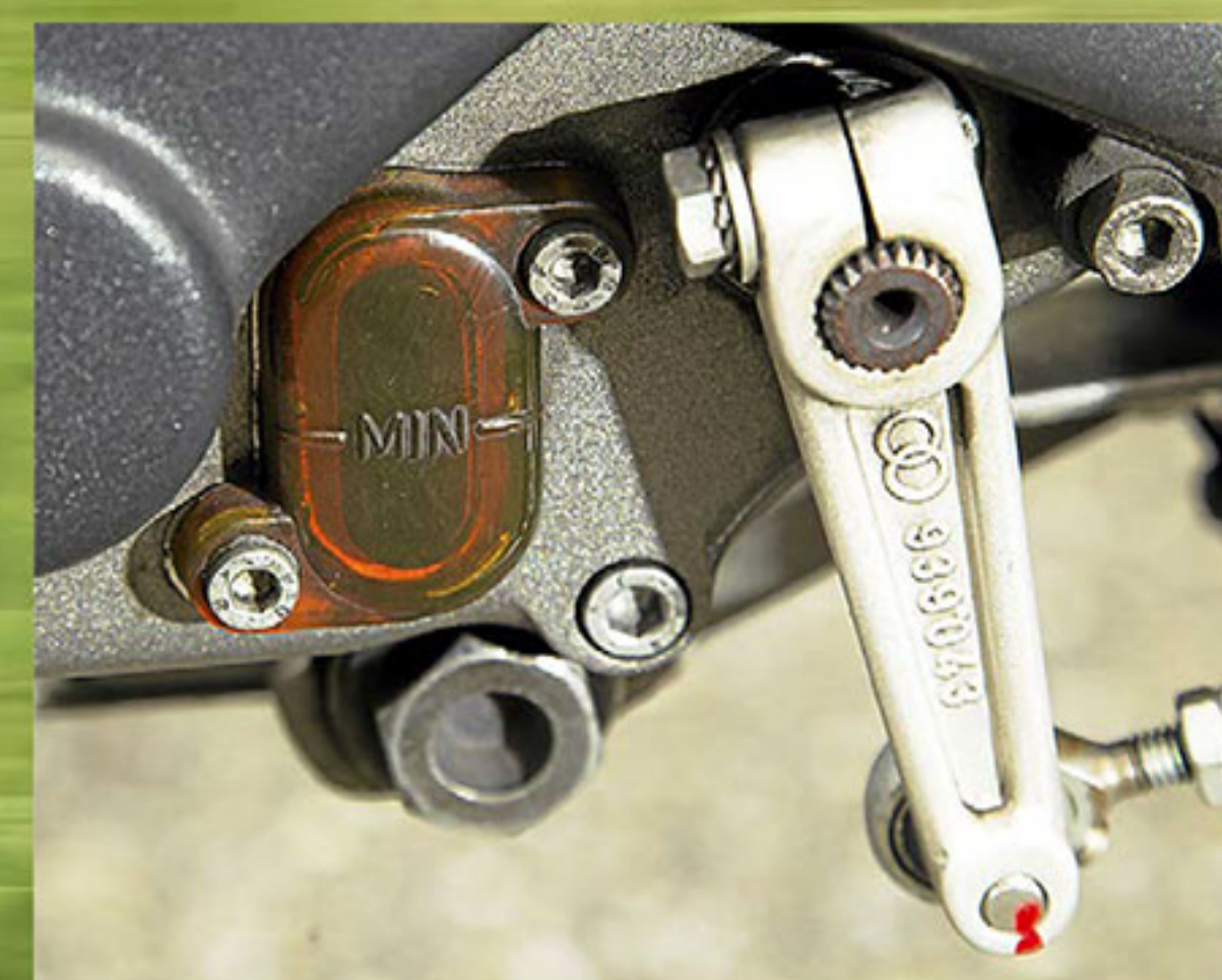
Sicher ist sicher: Ölstandkontrolle via Schauglas. Die Schrauben des Schaltgestänges hat Tom mit Loctite gesichert
