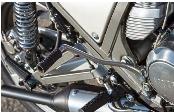
Gilera und Honda können, die SRX aber muss angekickt werden, E-Starter Fehlanzeige. Vorher Fußbraste hochklappen!
