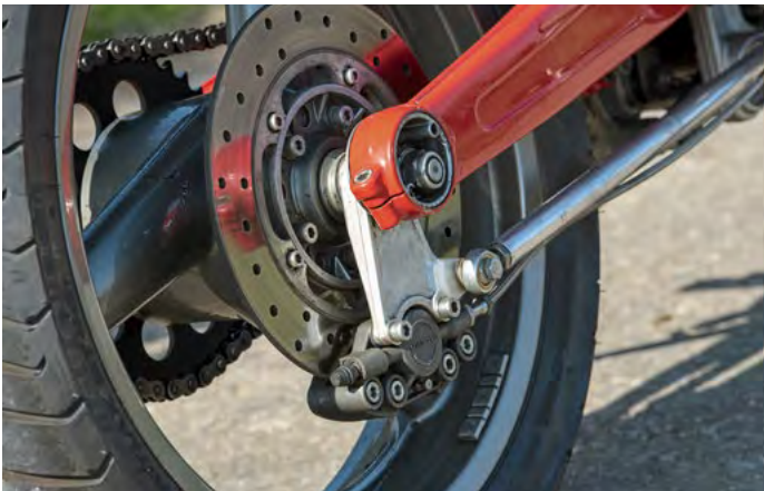
An den hinteren Enden der aus Blechprofilen gefertigten Schwinge erleichtern Achsexzenter das Spannen der Kette
