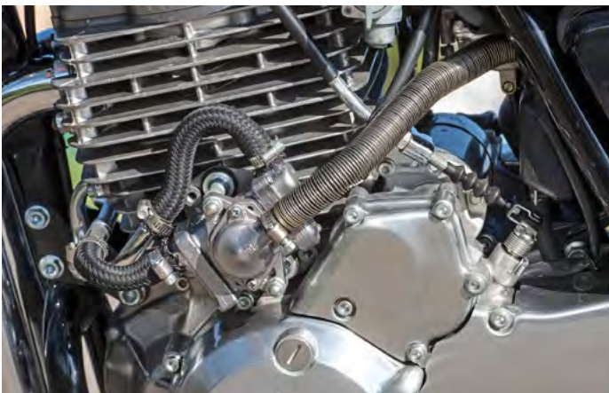
Strengere Abgaslimits in den USA ist das wenig klassische Sekundärluftsystem mit seinem Geschläch geschuldet
