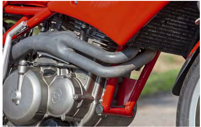
Über die Auslass-Ports des Singles entweicht das Abgas in die wohl-, aber nicht aufdringlich tönende Lafranconi-Tüte
