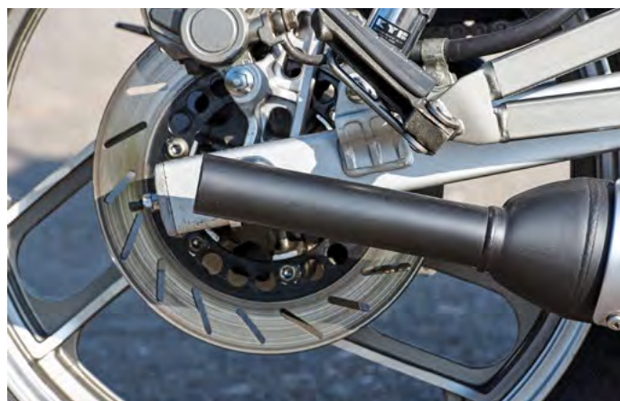
Die Auspuffverlängerung verlangte die Schweiz, wo die Mündung hinter der Radachse liegen musste
