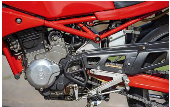
Der dohc-Single der Saturno hängt in einem nach unten offenen Gitterrohrrahmen aus Stahl
