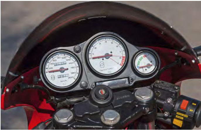
Im aufgeräumten, dank weißer Zifferblätter hübschen Cockpit verrät die Temperaturanzeige die Wasserkühlung
