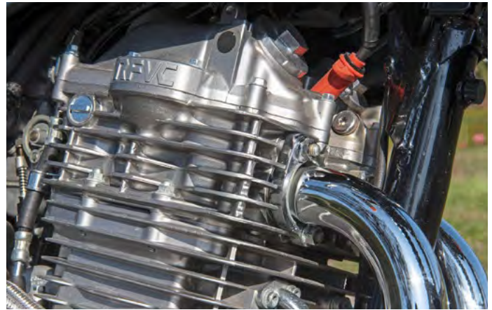
Statement in vier Buchstaben: RFVC steht für die Konstruktionsweise – „Radial Four Valve Combustion Chamber“
