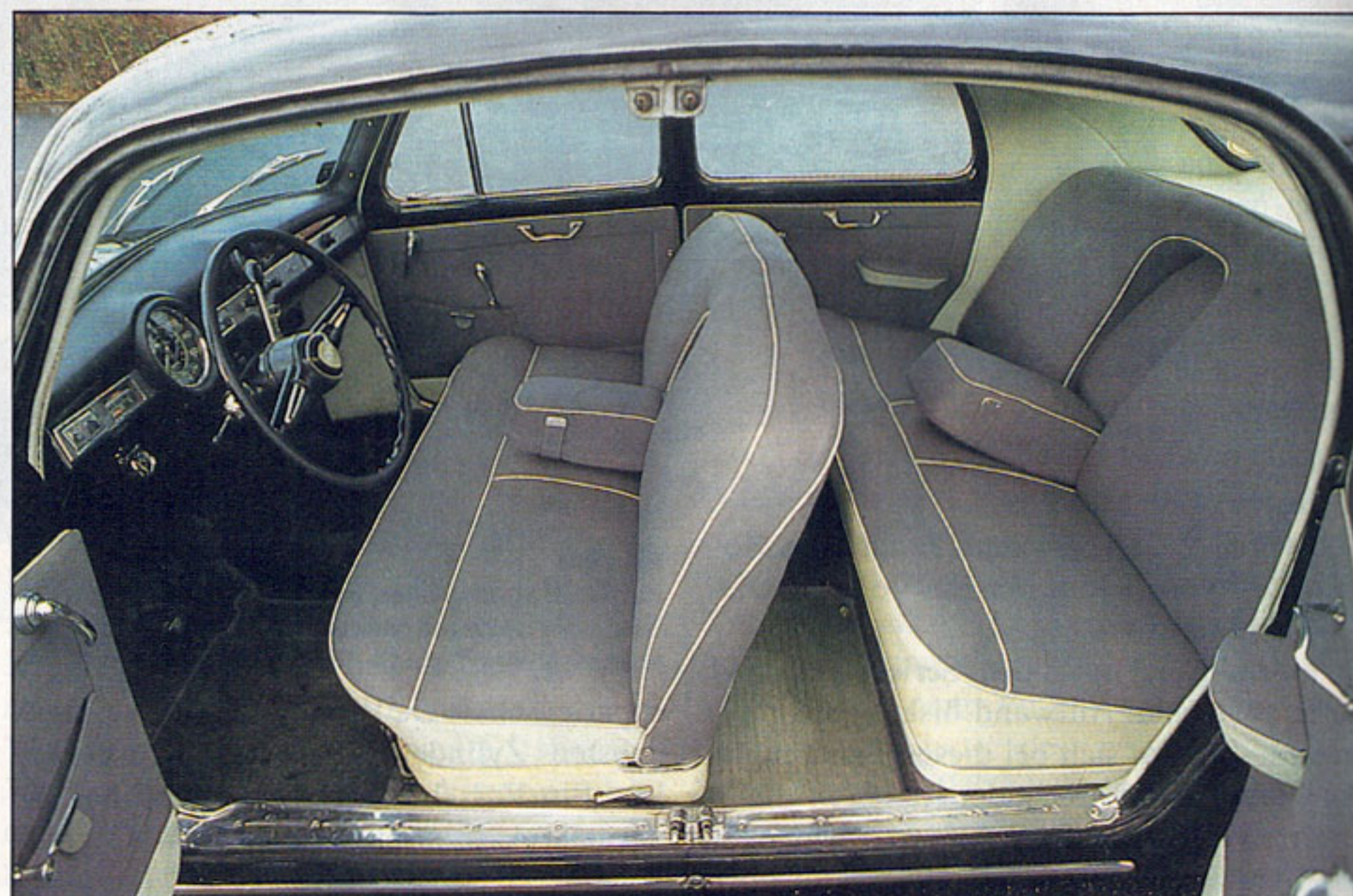
Hereinspaziert! Der Einstieg in den Fond dieses B 12 ist eine bequeme Angelegenheit — die fehlende B-Säule macht's möglich. Die hinteren Türen lassen sich allerdings erst nach den vorderen öffnen.
