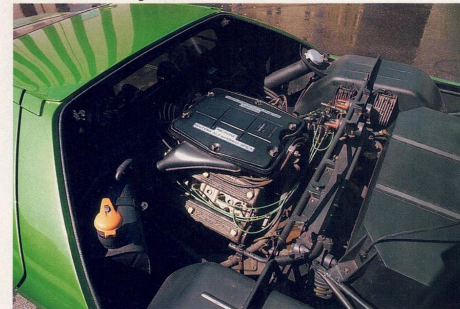
Der ursprüngliche Doppelzündungs-Motor des Stradale wurde durch ein Montreal-Triebwerk ersetzt (oben). Die geöffneten Türen erinnern an hochgestellte Flügel eines Käfers – daher der Name Carabo (links). ▷
