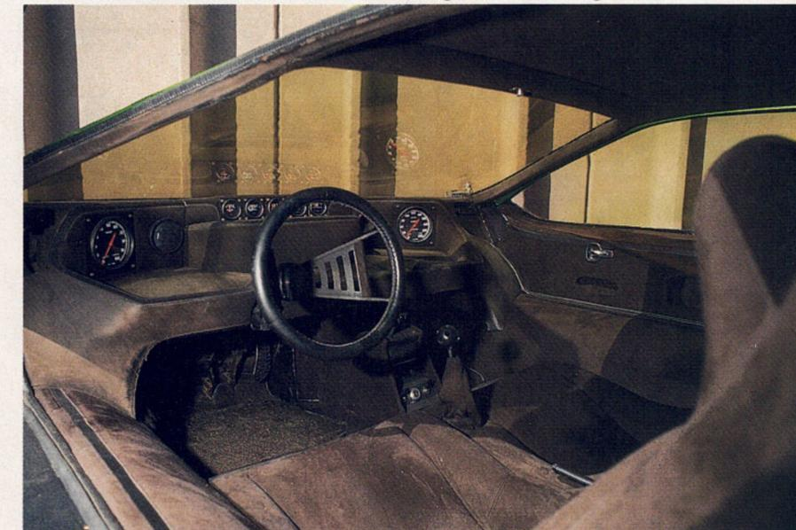
Die Instrumente sind weit vom Fahrer entfernt postiert und spiegeln in der Frontscheibe. Die Konstruktion des gewählten Stradale-Chassis erzwang dicht nebeneinander angeordnete Sitze.
