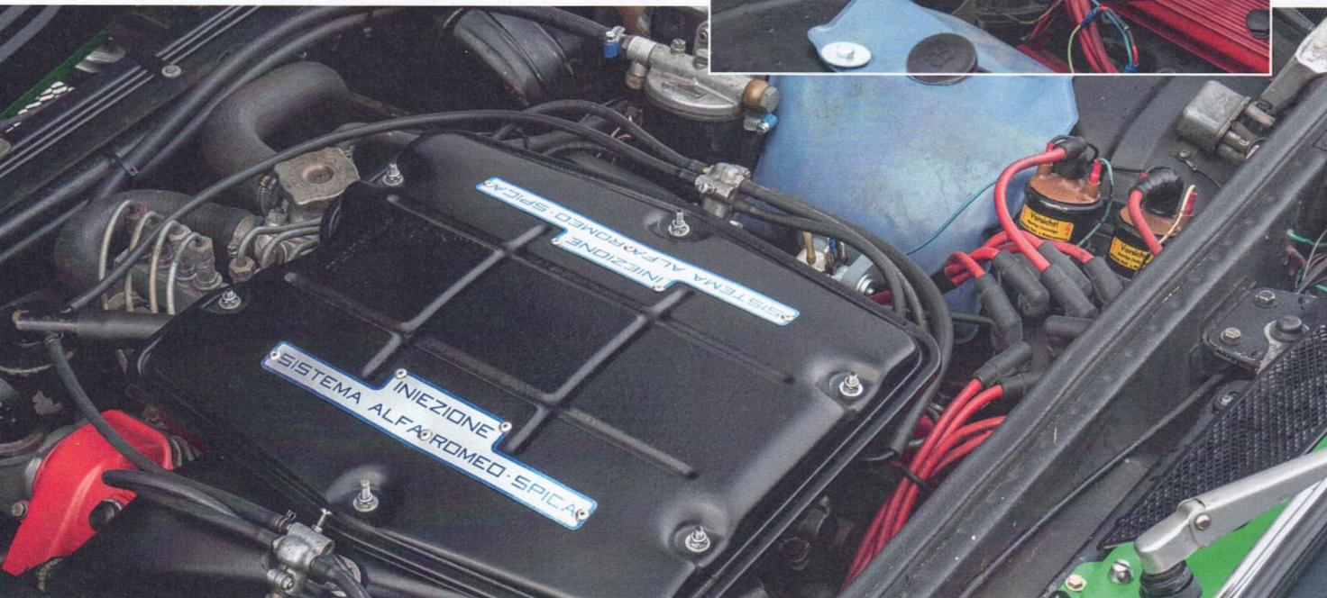
Der V8-Motor entstammte dem Tipo 33 Stradale – der Hubraum wurde auf 2,6 Liter vergrössert, die Leistung auf 200 PS reduziert. Die Doppelzündung gab es nicht mehr, dafür die mechanische SPICA-Saugrohreinjection.
