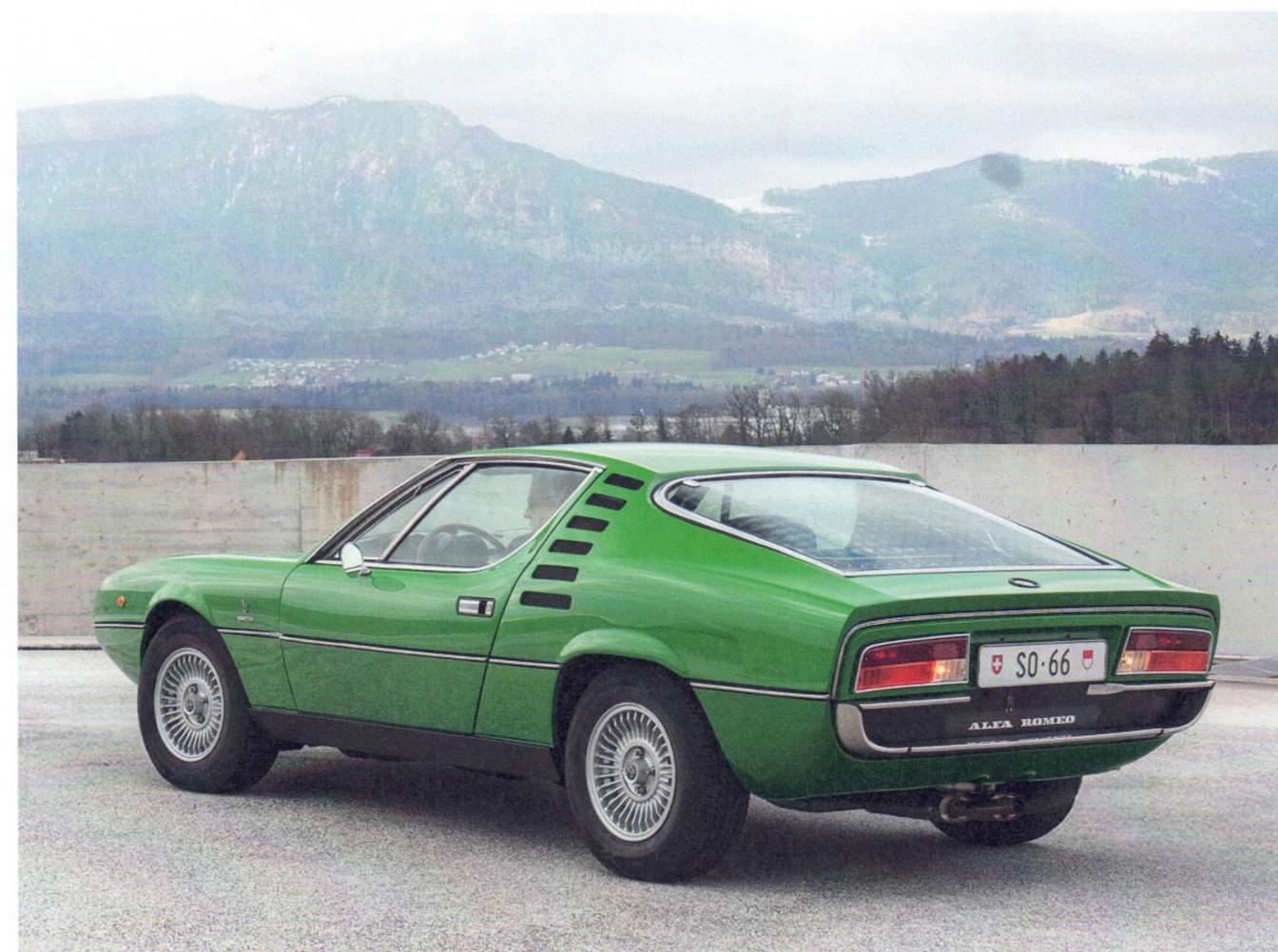
Eine Länge von 4.22 Meter und ein Radstand von 2.37 Meter: Der Alfa Romeo Montreal hat kompakte Abmessungen.
